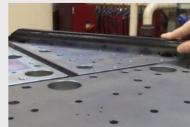
Ebenheitskontrolle nach dem Härten mit einem Kontrolllineal.
